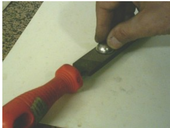
Igualamos el borde hasta que este recto, cuidado que se calientan los dedos..
