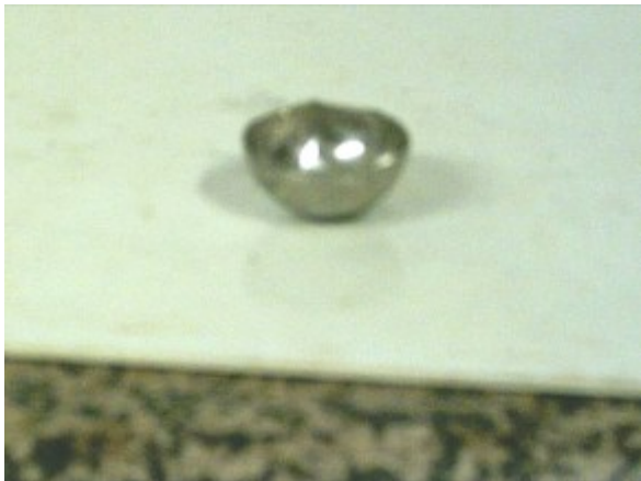
Debemos obtener un casquillo de 20 x 10mm con los bordes desiguales.
