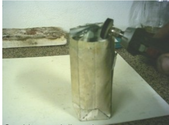
Cambiamos el disco de corte por uno de fieltro y pulimos con pasta de pulir
