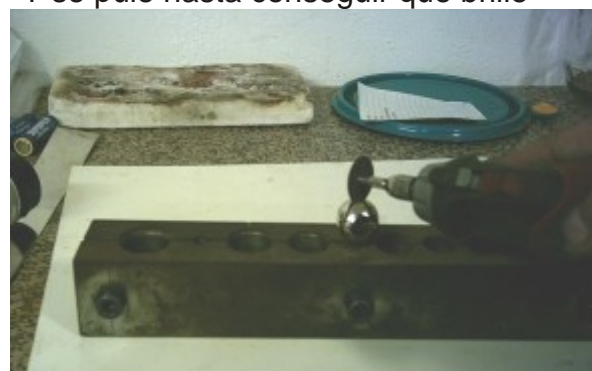
Se fija el cascabel por la anilla y utilizando un disco de corte de 0.6mm se hace el corte
