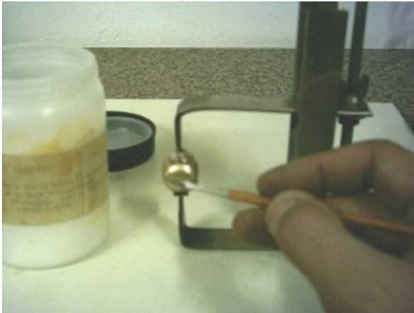
Mezclamos bórax con agua destilada y untamos la junta con un pincel
