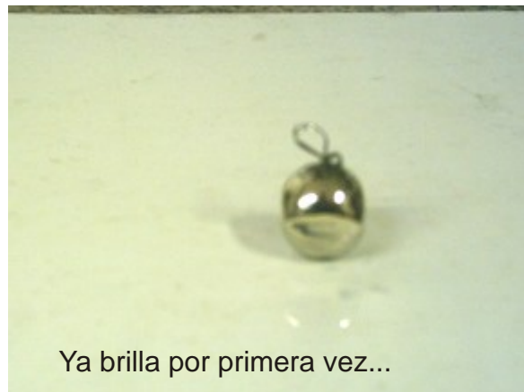
Utilizamos pasta de pulir con el disco de trapo
