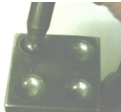
Embutidor de 18mm en cuenco de 28mm repetimos cuenco con embutidor de 17mm
