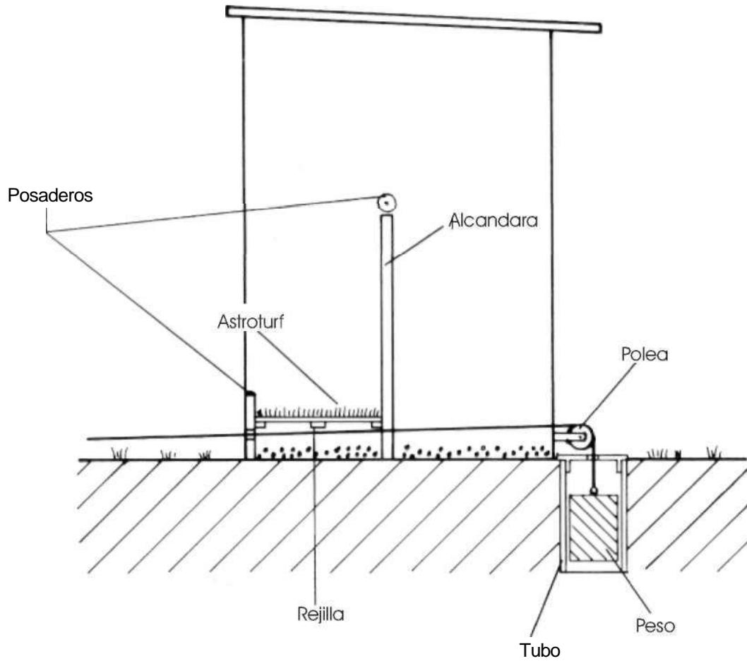
Sistema de tensado del cable de la trole por medio de un peso que se reserva dentro de un tubo
